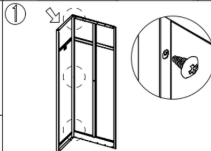
Sastavite lijevu stranu i stražnju ploču pomoću samoureznih vijaka.
