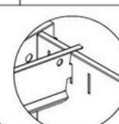
Paigaldage sahtli eesmine tihend vastavalt joonisele.
