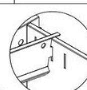
Monter den forreste skuffetætning som vist på billedet.
