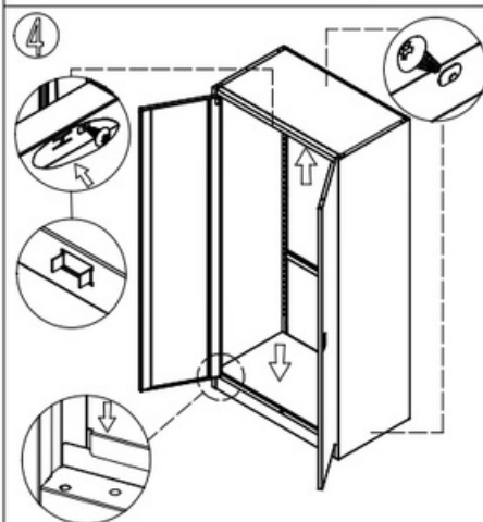
Kinnitage vasak külg ja tagapaneel isekeermestavate kruvidega (5x10).
