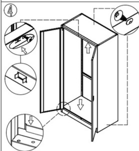
Закріпіть ліву сторону та задню панель самонарізними гвинтами (5x10).
